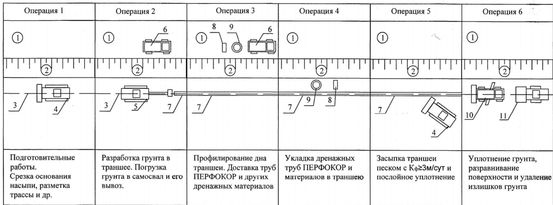
Рисунок 7.1 - Общая технологическая схема устройства траншейного дренажа с применением труб ПЕРФОКОР
